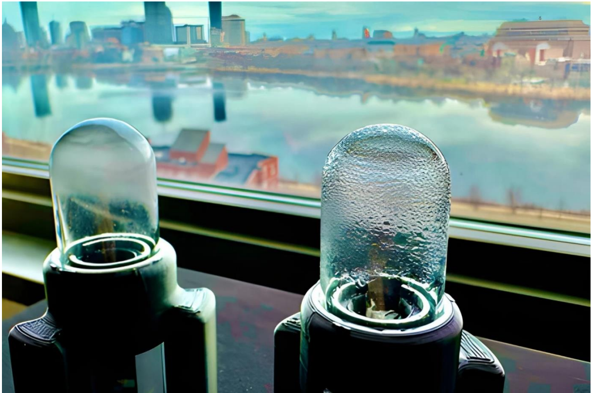
Twee prototypes van het ultrasonice apparaat, met rechts het water dat het in slechts enkele minuten losschudde.
